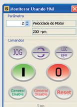
Janela de monitoração e comando utilizando HMI virtual. Função liga/desliga, JOG, local/remoto, reversão e reset
